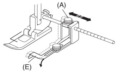
4. Die Flügelschraube (F) lösen und die Führung (E) mittels Vor-/Rückwärtsbewegung in die passende Position bringen.
