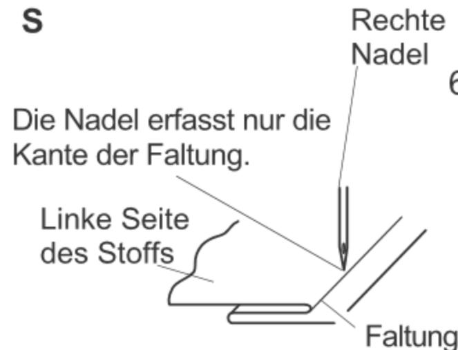
3. Legen Sie den Stoff mit der linken Seite nach oben so an, dass die Faltung links entlang der Stoffführung läuft.
