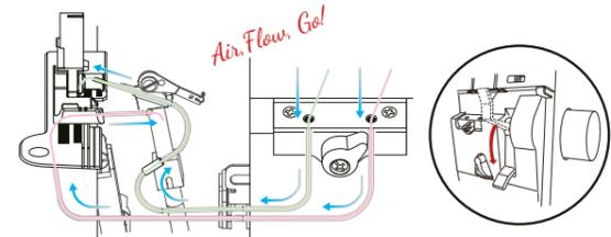
Durch einfaches Anheben und Absenken des Greifereinfädelhebels wird eine ausreichende Menge Luft gesammelt und zum Einfädeln der Greifer durchgepustet. Egal wie schnell der Hebel betätigt wird, die Luft strömt gleichmäßig aus, wenn der Hebel den Boden erreicht. Dieses Hebel-Lufteinfädel-System schafft optimale Bedingungen, für ein zuverlässiges Lufteinfädeln. Sie können Overlock einfädeln ... **Air, Flow, Go!**
