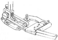
1. Nadel und Fuß heben. Die Breite mit Schraube (b) für das Band passend einstellen. Das Schrägband in die Bandführung einführen und es unter den Raupen bis hinter den Fuß ziehen. Das Band soll gut geführt sein und flüssig laufen können.
