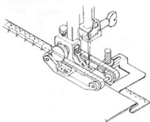
6. Mit dem Nähgut in Position auf der Nähmaschine die Halteschraube lösen und die Führung so justieren, dass die Bruchkante des Saumes an der Innenseite der Führung anliegt. Die Halteschraube wieder anziehen.
