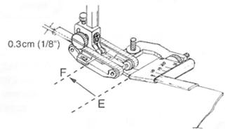
3. Den Einfasser so justieren, dass die Nahtbreite bei 0,3 cm liegt. Den Stoff und das Band von Position E nach F verschieben. Den Fuß senken und die Nadelposition überprüfen.
