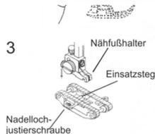
3. Den Raupenfuß so unter den Fußhalter legen, dass der Steg des Fußes unter der Rille des Halters ist liegt. Den Fußhalter senken. Der Fuß rastet ein.
