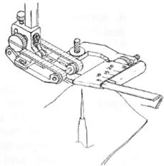
2. Den Stoff z. B. mit einer Scherenspitze in den Seitenschlitz (d) einführen, bis der Stoff komplett vom Schrägband ummantelt wird.
