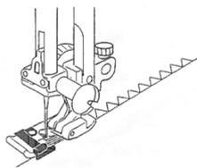
1. Bei leicht fransenden Stoffe zunächst die Kante mit einem Overlockstich versäubern. Dazu den entsprechenden Fuß an der Maschine anbringen und die Kanten versäubern.
