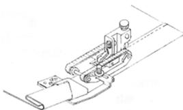
5. Die Halteschraube (a) lösen und die Führung so justieren, dass der Saum im Abstand von 3 mm von der Kante genäht wird.
