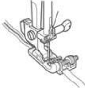
Der Pailletten- / Bandnähfuß dient zum exakten Aufnähen von Zier- und Gummibändern. Dieser Fuß hat vier verschiedene Führungswege (4mm; 5-6mm; 7mm; 8-10mm) durch die das Band unter die Nadel geführt wird. In Kombination mit der „Führung zum Nähen von Bändern“ können wunderschöne individuelle mehrlagige Dekorbänder gefertigt werden.
