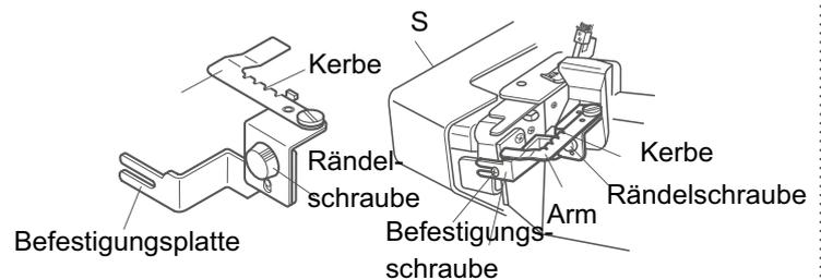
**Hinweis:** Wenn der Kräuselaufsatz an der Maschine angebracht ist, kann die Greiferabdeckung nicht geöffnet werden. Um die Greiferabdeckung zu öffnen, entfernen Sie erst den Aufsatz.
