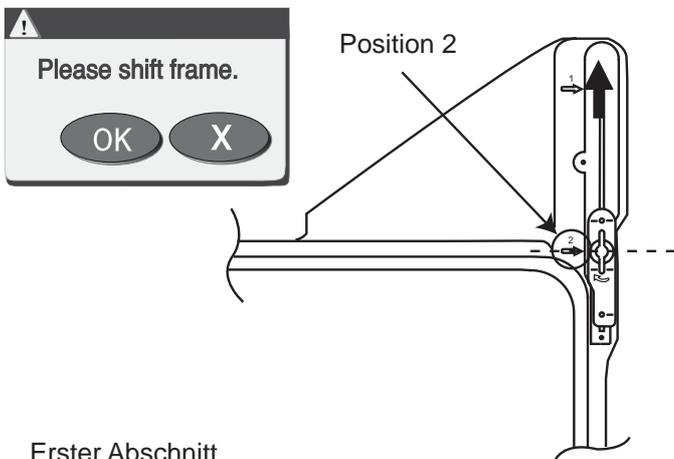
5. Eine weitere Nachricht erscheint. Drücken Sie die Taste OK. Lösen Sie den Feststeller, verschieben Sie den Stickrahmen auf Position 2 und sichern Sie den Stickrahmen wieder.
