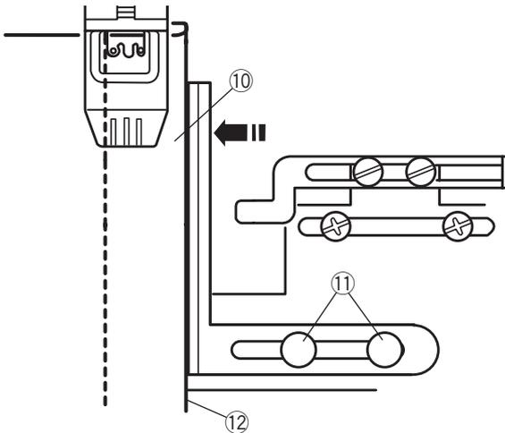
5 Lösen Sie die Halteschrauben und schieben Sie die Stoffführung nach links, bis diese die Saumkante erreicht. Die Schrauben wieder festdrehen.
