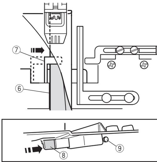
4 Die bewegliche Führung wird mittels des weißen Hebels unter der Saumführung nach rechts in den Saum geschoben (siehe Abbildung).
